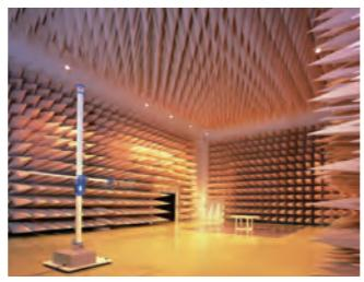
EMC関連の測定評価を行う大型電波暗室
